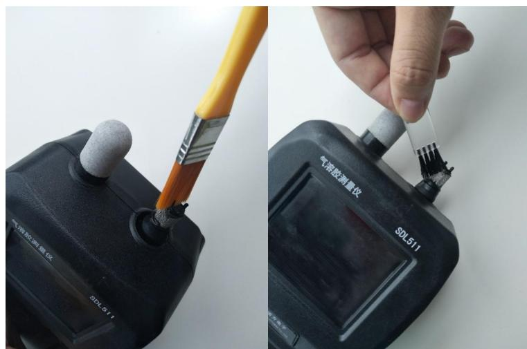
步骤四：进气口和滤网都清理完成后，将气体采样探头组装好，重新装回设备上。特别注意要保证黑硅胶密封管两头分别与滤网和传感器进气口安装紧密。
